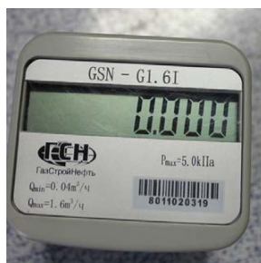
Рисунок 1. Внешний вид счетчика газа бытового GSN-G1.6I
